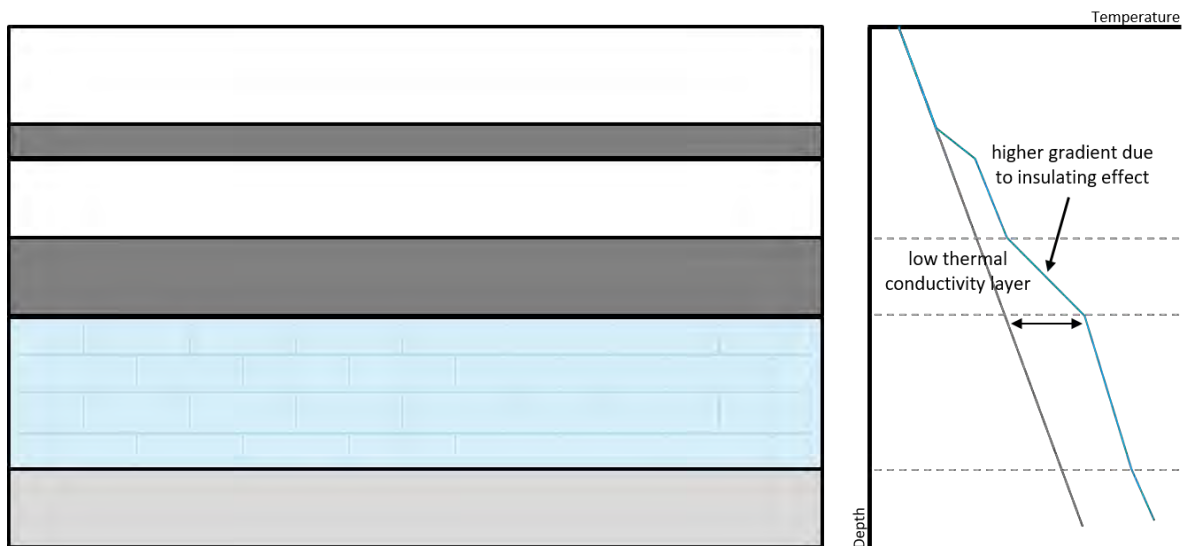
Figuur 29: Schematische weergave van het effect van lagen met verschillende thermische conductiviteit op de temperatuursgradiënt in de ondergrond.
