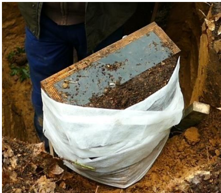
Figuur 22: Omwikkelen van de monoliet met afdekfolie.
