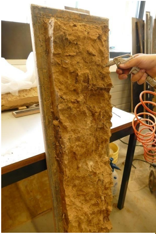
Figuur 31: Bewerken van de monoliet met perslucht.
