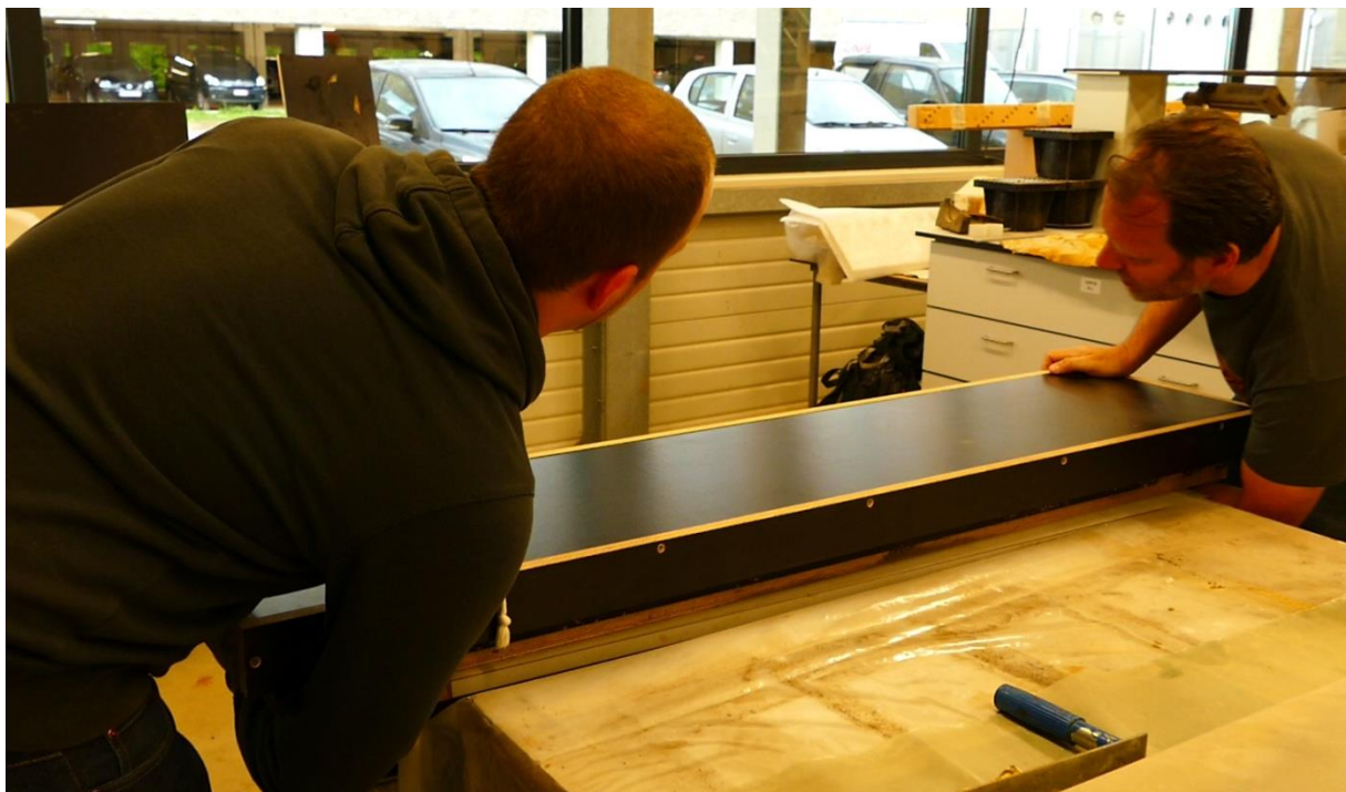
Figuur 26: Omdraaien van het geheel (monoliet, draagplaat en muggengaas tussenbeide).
