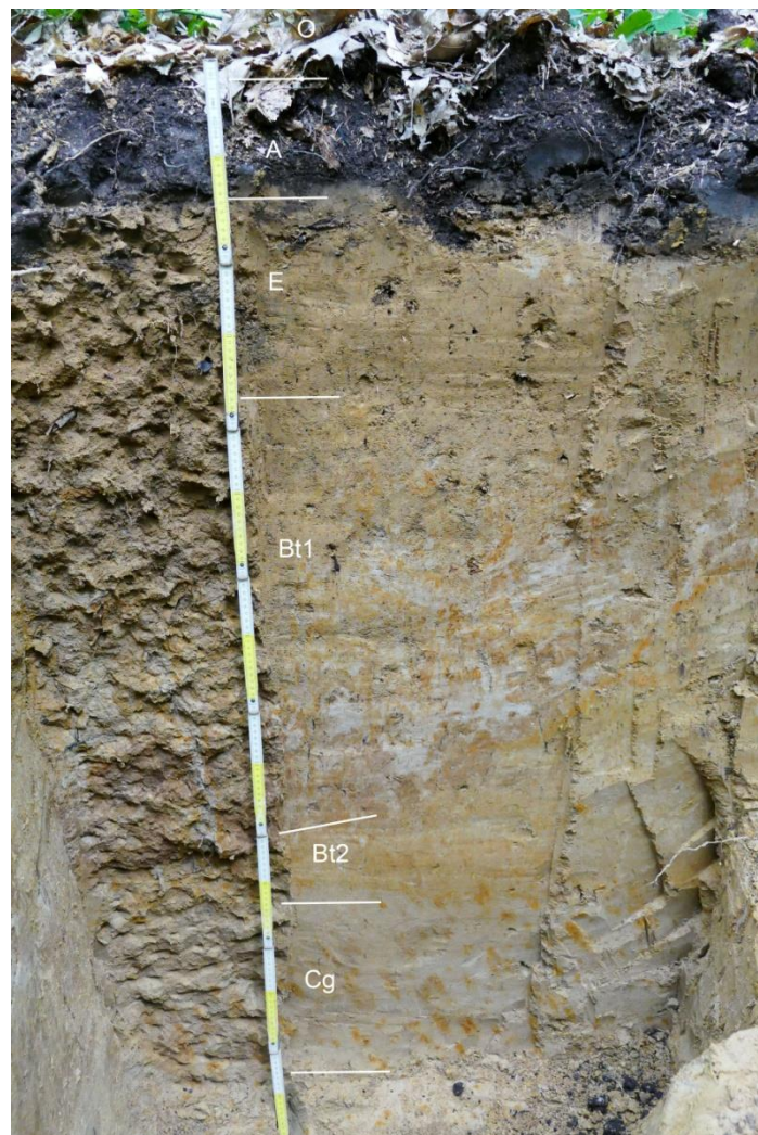
Figuur 41: Profiel "GER-1" Noordwand, droge leembodem met textuur B horizont.
