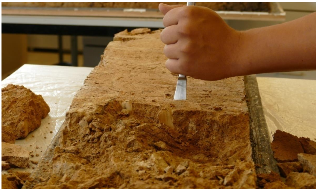
Figuur 30: Bewerken van de monoliet met een beitel. Door het werken in één richting worden de zichtbare inkepingen steeds met de volgende handeling verwijderd.
