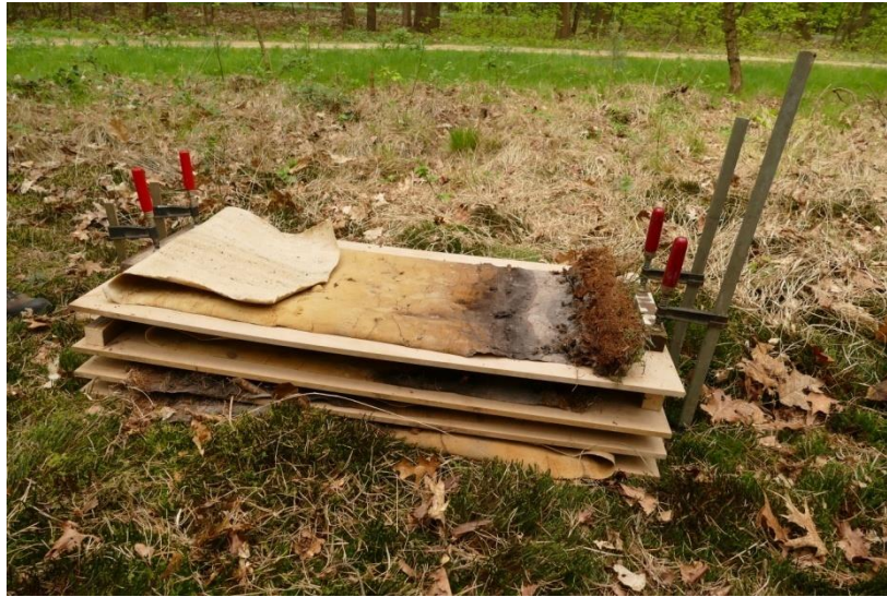
Figuur 12: Stapeling voor vervoer. Belangrijk hierbij is dat de lakprofielen elkaar niet raken.
