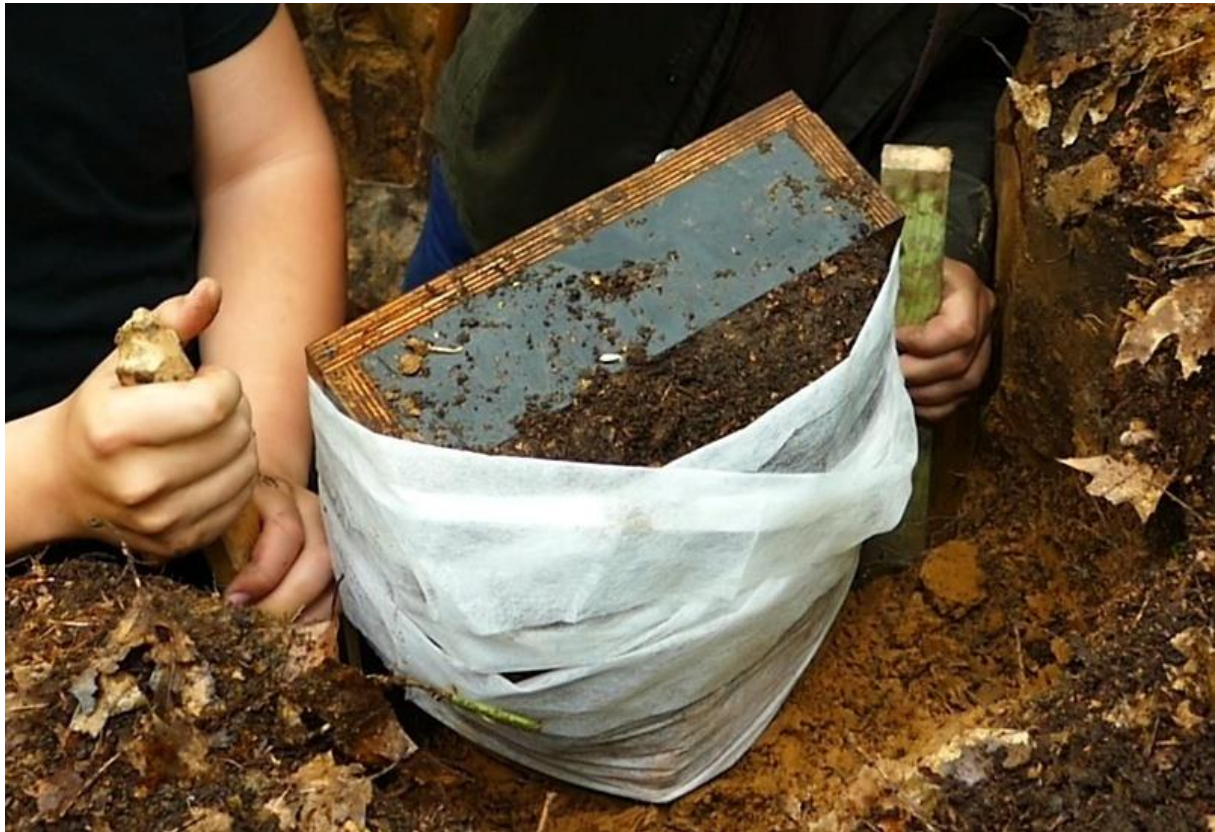
Figuur 23: Lossnijden van de monoliet met behulp van metaaldraad.
