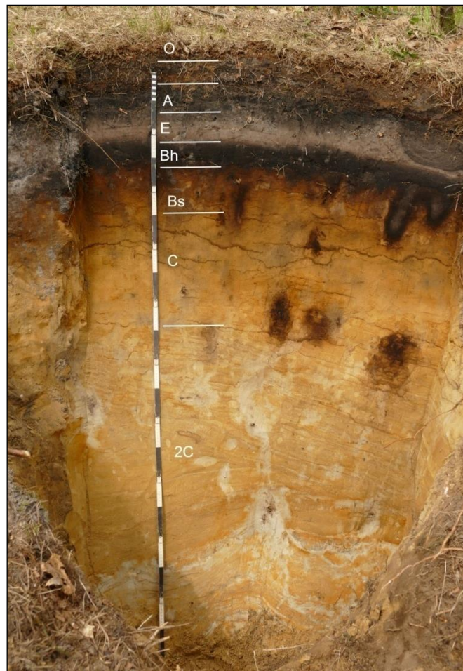
Figuur 40: Profiel "KAL-02" Noordwand, matig droge zandbodem met duidelijke ijzer en humus B horizont.
