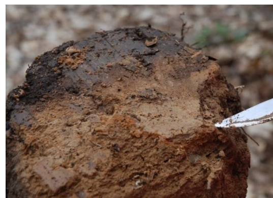
Figuur 37: Oppervlakkige compactie: een sleepspoor is te zien.
